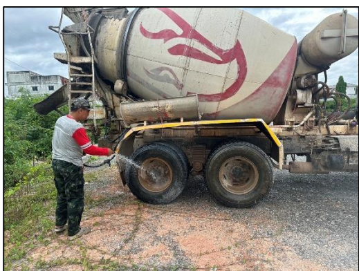
ภาพที่ 17 พื้นที่ล้างล้อ และกิจกรรมล้างล้อรถบรรทุก
